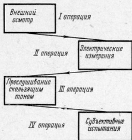
Рис. 127. Схема операций контроля отремонтированной головки
