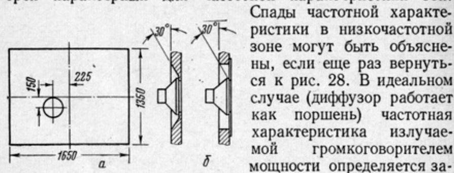
Рис. 46. Стандартный акустический экран для измерения головок громкоговорителей (ГОСТ 16122—70): а — экран; б — методы крепления головок
