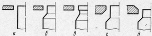
Рис. 19. Схемы полюсных наконечников магнитных цепей:
