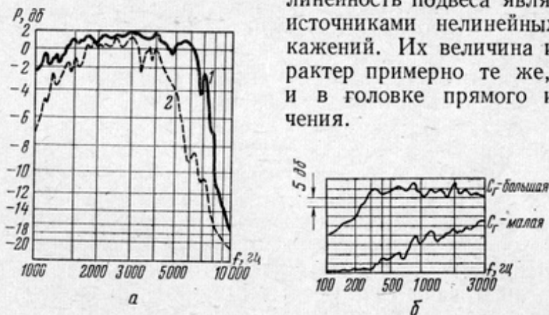
Рис. 67. Влияние высоты \Delta_k предрупорной камеры ( a ) и гибкости подвеса ( b ) на частотную характеристику рупорной головки:
