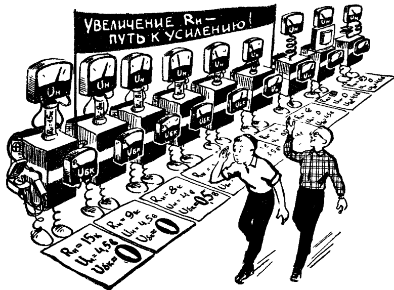
Рис. 38. При слишком большом сопротивлении нагрузки постоянное напряжение на коллекторе может упасть до нуля.
